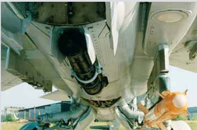
Шестиствольная 30-мм пушка ГШ-6-30 в составе системы вооружения истребителя-бомбардировщика МиГ-27
