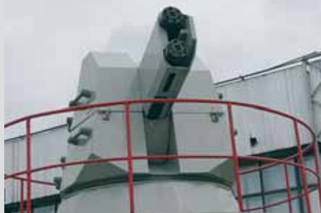
Новый корабельный артиллерийский комплекс «Дуэт» имеет скорострельность 10 тыс. выстрелов в минуту. Здесь также пушки конструкции В.П. Грязева
