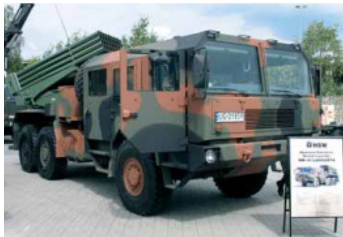
WR-40 Langusta на шасси Jelcz P-662 является глубокой модернизацией БМ-21 «Град» с дальностью пуска ракет до 40 км
