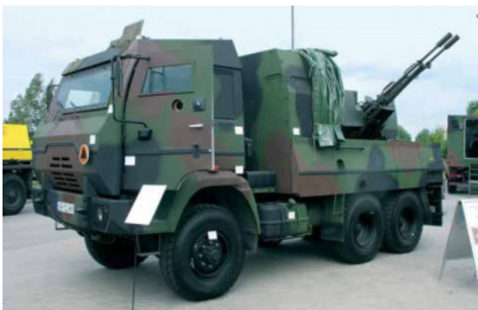
Hibernit Star-266M с 23-мм зенитной установкой ЗУ-23-2 был создан для сопровождения конвоев в Ираке и Афганистане
