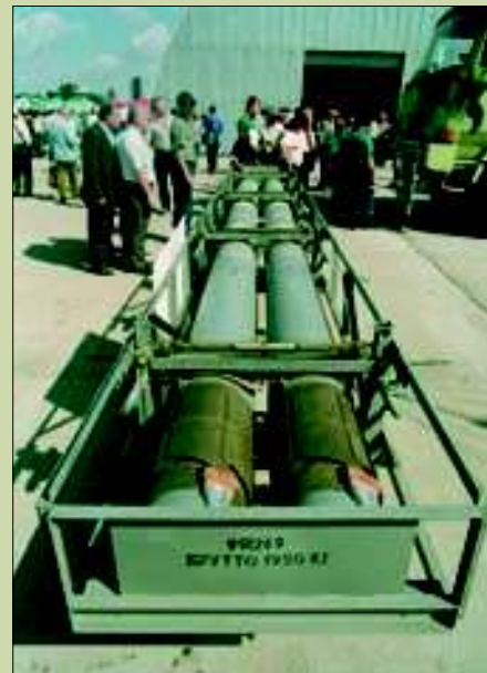
300-мм ракеты комплекса 9К59 «Смерч» имеют массу почти 800 кг 300-mm 9K59 Smerch rockets weigh almost 800 kg.
