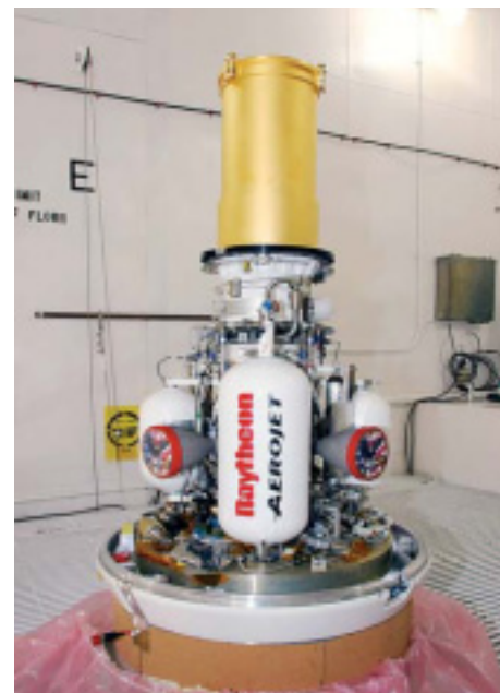
ГСН и боевая ступень EKV перед установкой на ракете
