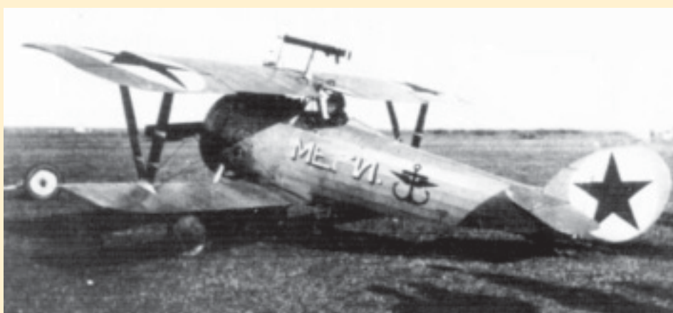
Самолет-истребитель типа «Ньюпор-XXIV» 1-го Морского истребительного авиаотряда (1919 г.).
