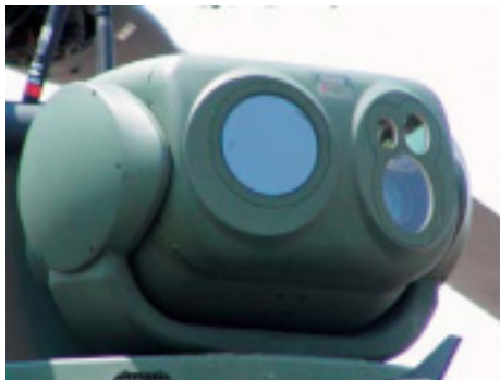
Визирная головка станции разведки и целеуказания.
