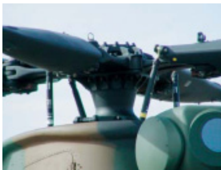
Втулка несущего винта и тяги автомата перекоса.
