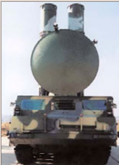
Пусковая установка 9А82 со станцией подсвета цели и ЗУР 9М82 ЗРС С-300В
