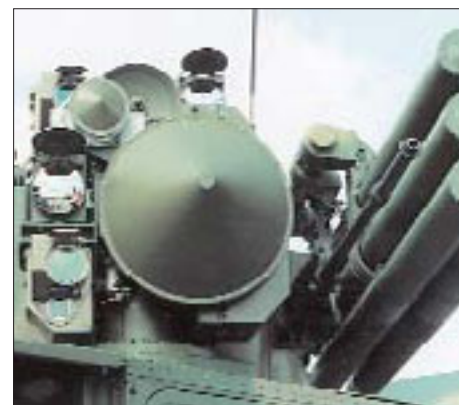
Башенная установка с вооружением, приводами наведения и колонками систем обнаружения и сопровождения
